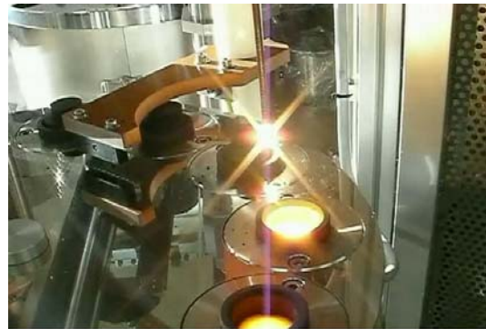
（写真1）燃焼合成装置
