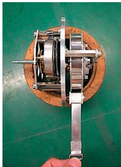
ゼンマイばね機構「スプリングモータ」
