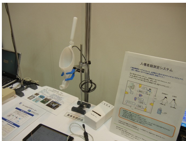
羽根車を利用した尿流量計
