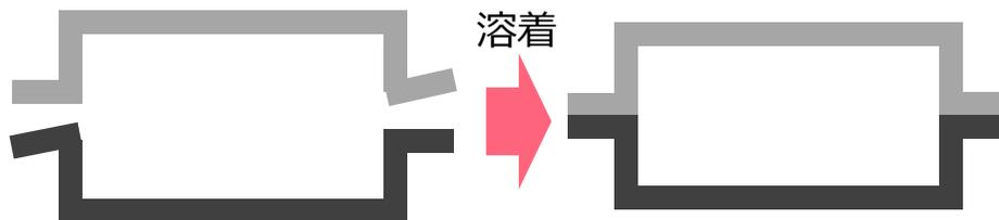
溶着前の部品には、少なからずそり変形があり、加圧矯正しながら溶着しています。
