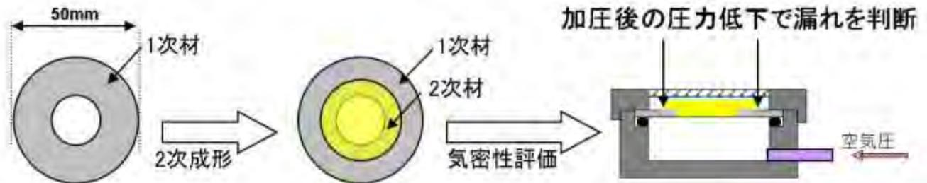
空気圧：0.5MPaにて母材破壊
