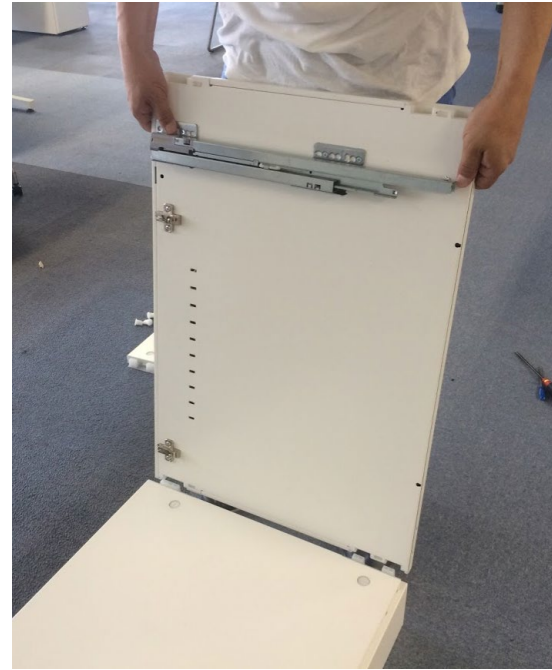
ストライカー（凸部）を備えた底板に対して キャッチ（凹部）を備えた側板を上から嵌める様子
