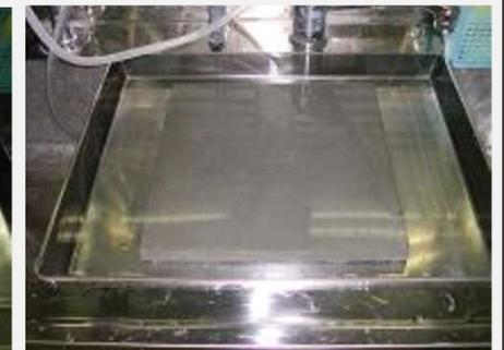
水に沈むコンクリート平板
