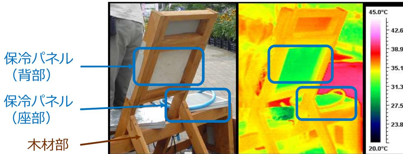
屋外に設置される椅子の構造材として利用される木材と比較してその表面温度は低く、気温を上回ることなく座部、背部を冷却。
