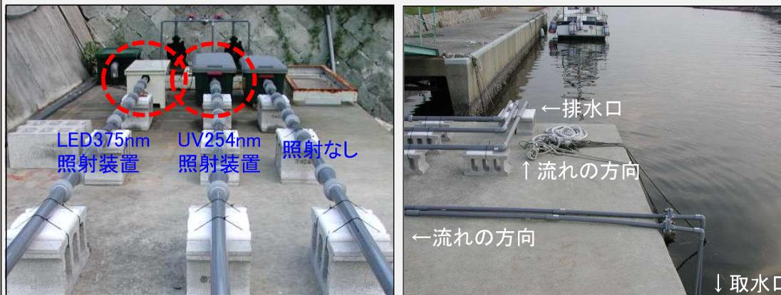
小型流水モデル水路の設置状況 (LED375nm、UV殺菌灯254nm、照射なし)
