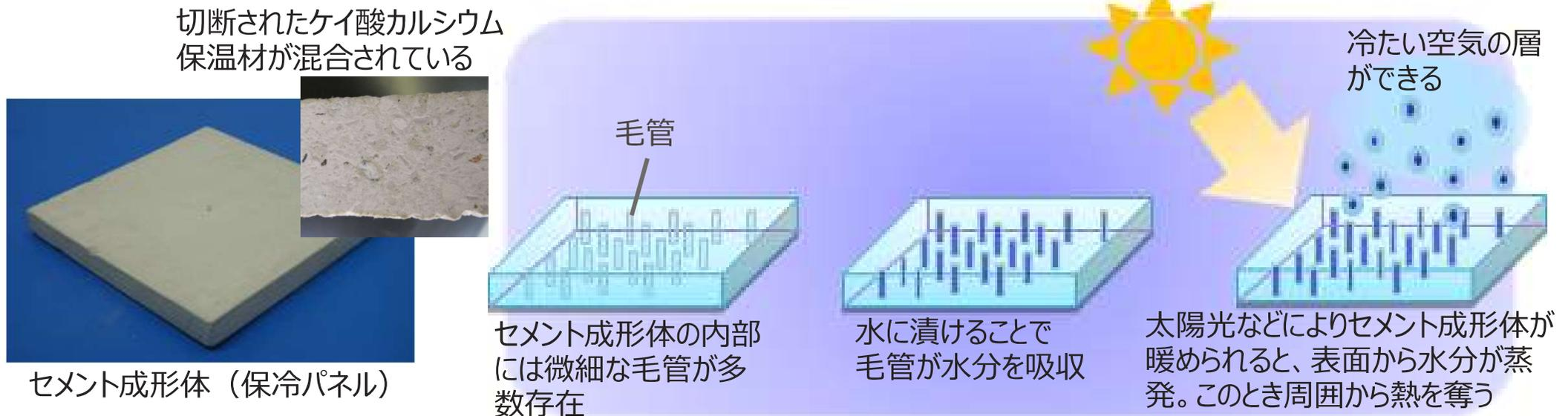
このセメント成形体を利用すれば、水分の蒸発により発生する気化熱で、周囲の熱を奪う保冷パネルができる。
