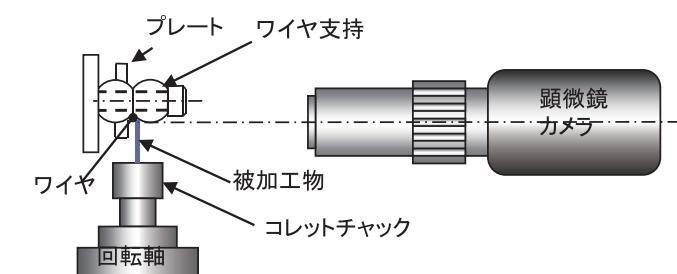
《事例：軸加工高アスペクト比加工》
