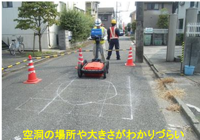
従来の路面下レーダー探査結果確認方法
