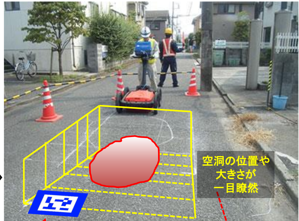
特許を応用した路面下レーダー探査結果確認方法
