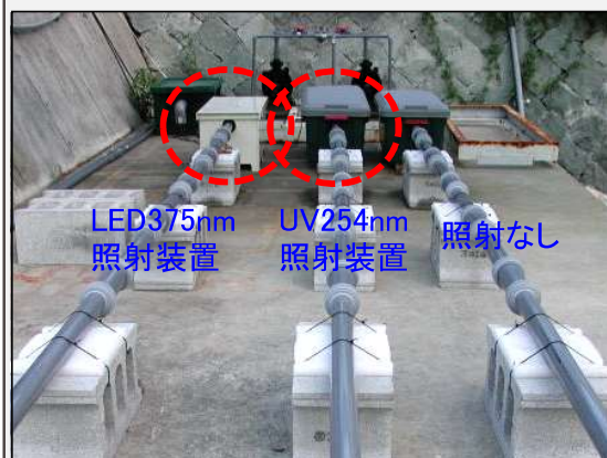
小型流水モデル水路の設置状況（LED375nm、UV殺菌灯254nm、照射なし）
