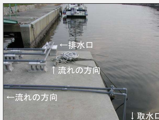
小型流水モデル水路の設置状況（LED375nm、UV殺菌灯254nm、照射なし）
