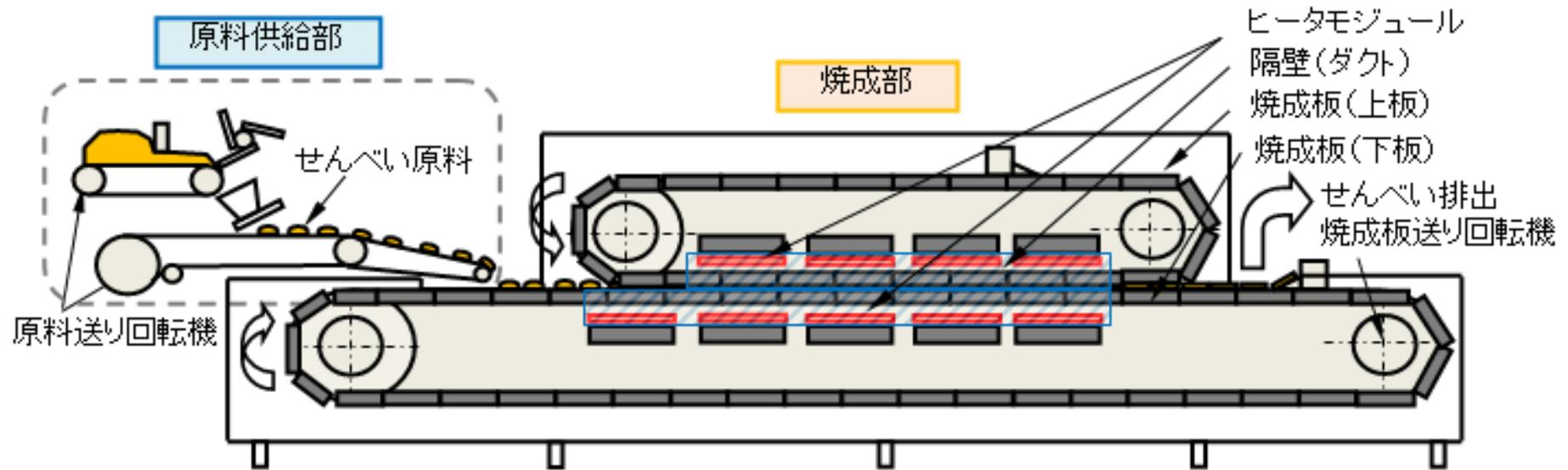
第3図 電気式焼成機の構成図
