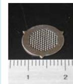
一円硬貨の1/6の範囲内に120個以上の穴を穴ピッチ公差3 $\mu$ m以下の高精度で順送プレスにて加工することに成功。従来の1/10の低コスト化を実現。
