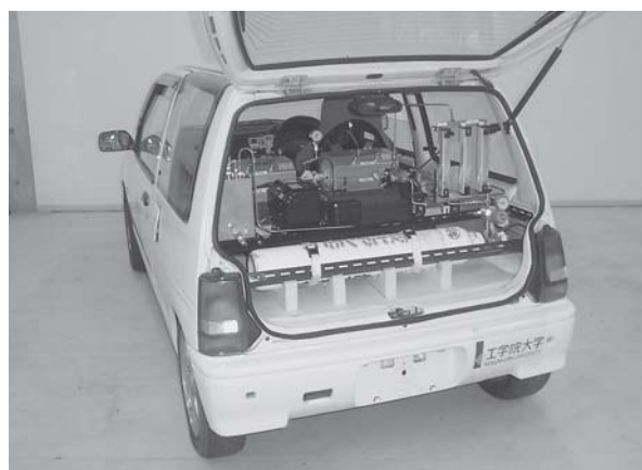
図4 試作したアンモニア分解システム搭載・燃料電池自動車
