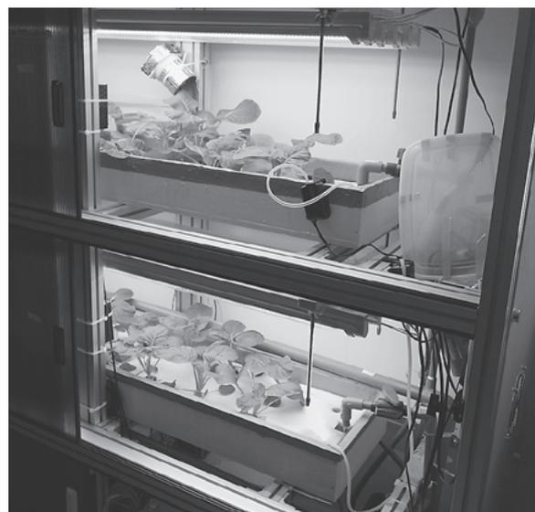
図4 植物工場の実験装置 (自作)
