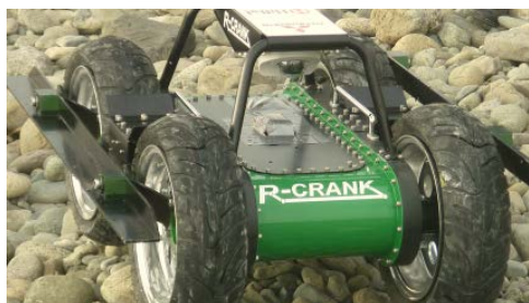
株式会社ハイボット 無人走行する災害状況遠隔調査車両 相模川での実証実験
