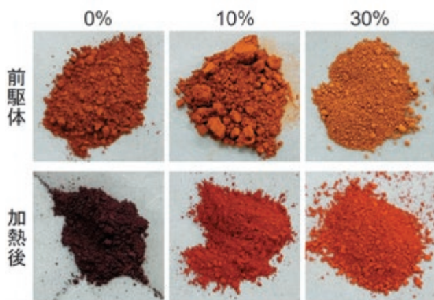
図2 試薬の種類とAl置換量による試料の色の变化
