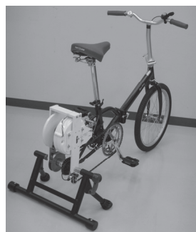
■専修大学 ネットワーク情報学部 「自転車型人力発電機」
