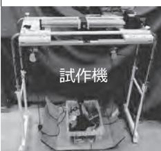
・試作機によって、80kg 金属重量物の左右引き上げ動作に成功。
