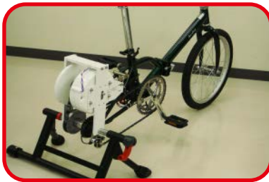
専修大学 ネットワーク情報学部 「自転車型人力発電機」
