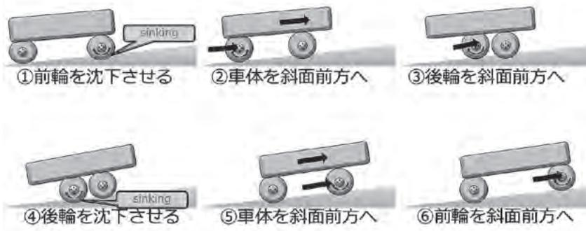
図3 Push Pull Locomotion型移動機構の仕組み
